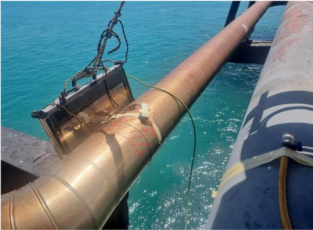
NDE Solutions verwendet den digitalen Flachdetektor DRA 3543 von DÜRR NDT seit 2021 in Kombination mit Iridium-192 als Strahlenquelle zur Durchführung von Corrosion-Under-Insulation (CUI)-Radiografie zur Überprüfung von Rohrwandverlusten in Öl- und Gasanlagen sowie Raffinerien. Der Detektor wird wöchentlich in 8-Stunden-Dauerschichten eingesetzt und dient der Erfassung von mehr als 60 Röntgenbildern pro Monat.
